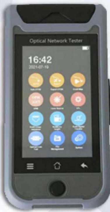
\* VFL (Luz visual láser) y OLS (Fuente de Luz) pueden ejecutarse en segundo plano, la multitarea puede operarse simultáneamente. Es posible usar la salida OLS de modo Continuo CW/Intermitente.
